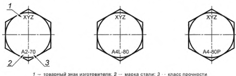
Рисунок 2 — Маркировка болтов и винтов с шестигранной головкой
