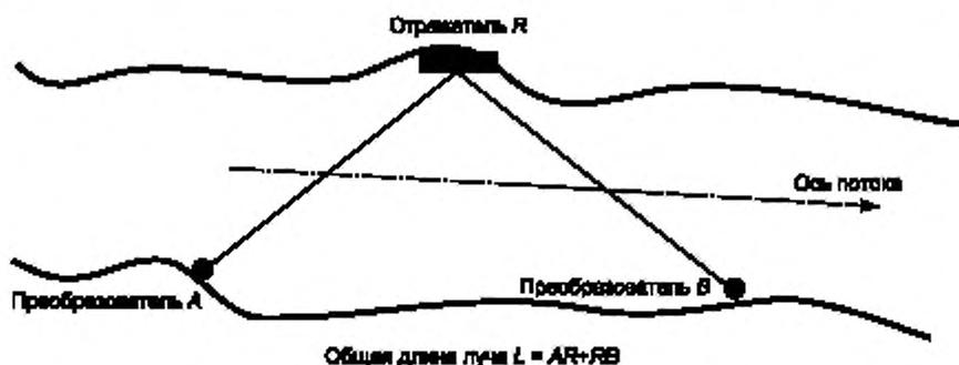
Рисунок 2 — Схема расположения преобразователей с отражением лучей
