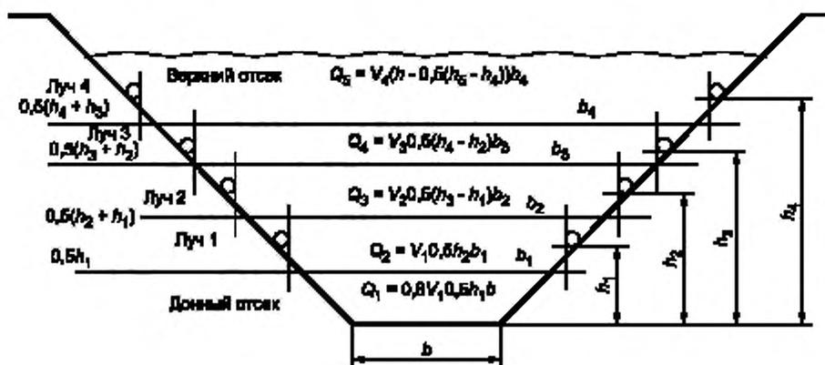
Рисунок 3 — Пример расчета расхода методом послойных сечений
