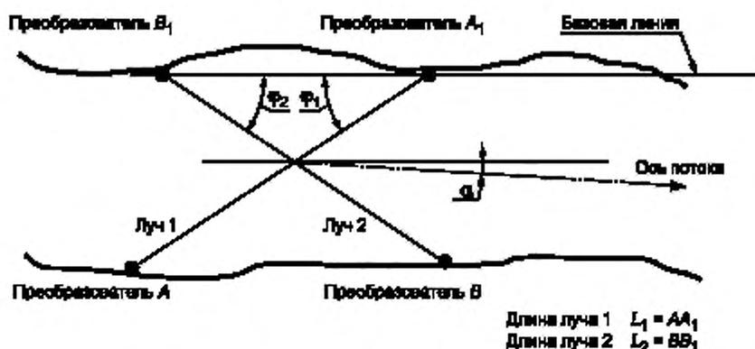
Рисунок 1 — Схема расположения преобразователей с пересекающимися лучами
