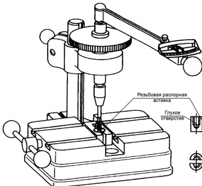
Рисунок 1 — Пример устройства для испытания на кручение
