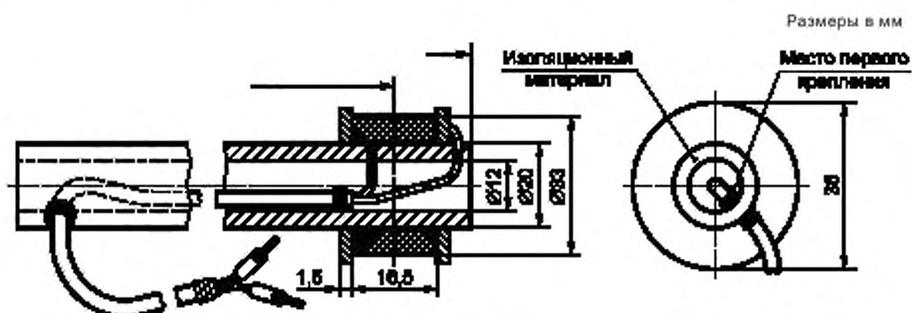
4500 витков эмалированного медного провода с диаметром 0,13 мм и сопротивлением 500 Ом
