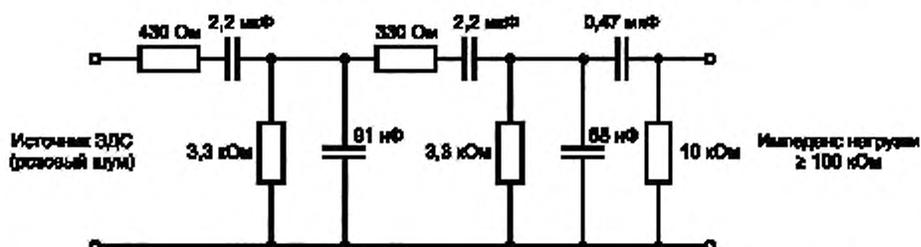
Выходной импеданс источника должен быть включен в значение сопротивления первого резистора (430 Ом). Влияние импеданса может быть учтено путем регулировки резистора сопротивлением 10 кОм. Тангенс угла потерь конденсаторов не должен превышать 0,005
