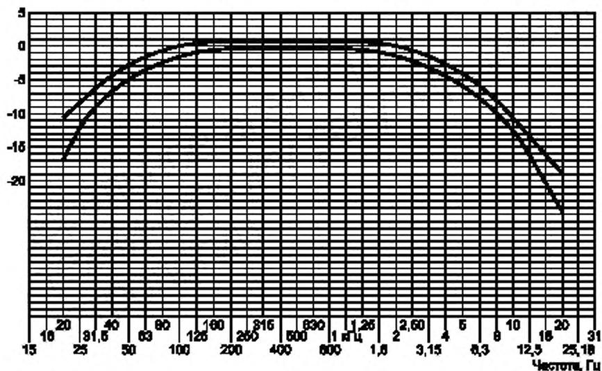
Рисунок 1 — Спектральная мощность моделируемого программного сигнала
