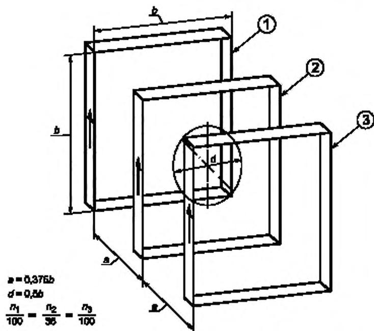
Рисунок 3 — Размещение трех катушек для создания однородного переменного магнитного поля
