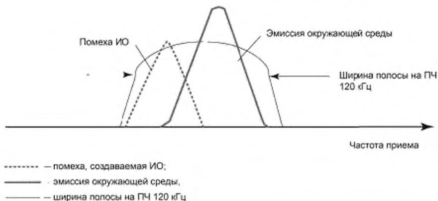
Рисунок А.3 — Помеха, создаваемая немодулированным сигналом (точная кривая)
