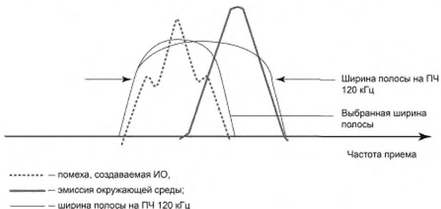
Рисунок А.4 — Помеха, создаваемая АМ-сигналом (точная кривая)
