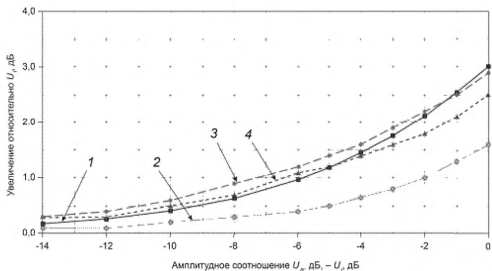
1 - уравнение (A.8); 2  $U_{\text{ср}}$  непрерывная волна,  $U_{\text{р}}$  непрерывная волна; 3  $U_{\text{ср}}$ : AM 99 %,  $U_{\text{р}}$ : импульсная модуляция,  $t_f = 1 \text{ мкс}$ ,  $t_r = 10 \text{ мкс}$ ; 4  $U_{\text{ср}}$ : AM 99 %,  $U_{\text{р}}$  непрерывная волна
