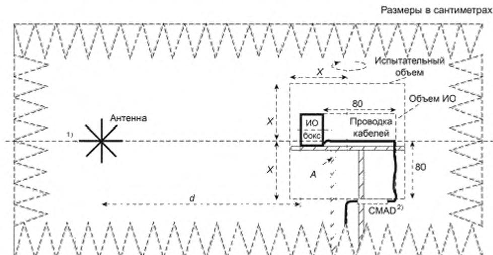
А — поворотная платформа и опора для ИО: 2X — 1,5; 2,5; 5 м; d — 3, 5 или 10 м
