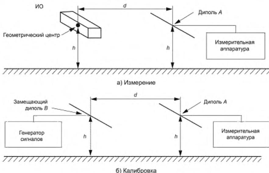
Рисунок 18 — Геометрия испытательной установки при методе замещения
