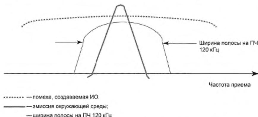
Рисунок А.7 — Помеха, создаваемая широкополосным сигналом (точная кривая)
