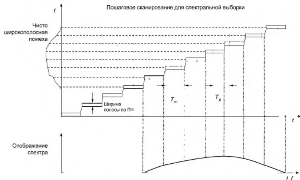
Примечание — Время измерения (задержки срабатывания)  $T_m$  должно быть больше времени повторения импульсов  $T_p$ , которое обратно пропорционально частоте повторения импульсов.
