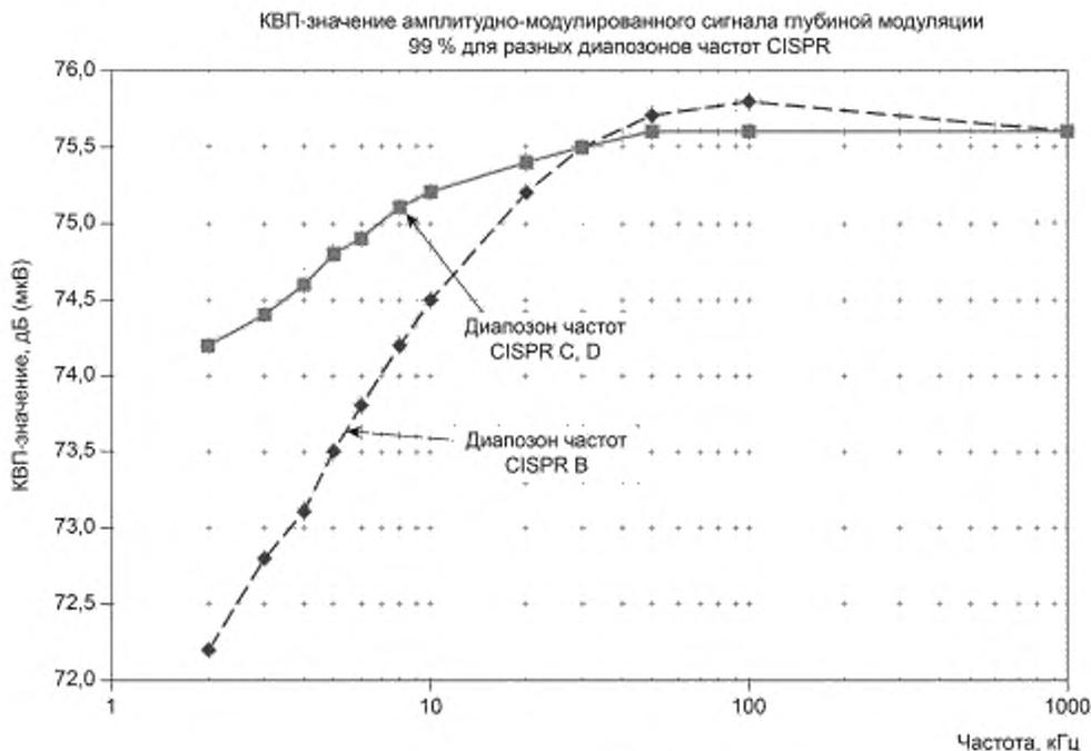
Рисунок А.5 — Показание АМ-сигнала в функции от частоты модуляции при квазипиковом детекторе в диапазонах В, С и D CISPR
