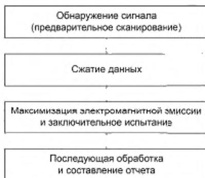
Рисунок 19 — Процесс, обеспечивающий уменьшение времени измерения
