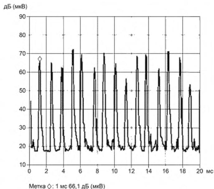
Примечание — Помеха от коллекторного двигателя постоянного тока: из-за количества коллекторных сегментов частота повторения импульсов высокая (приблизительно 800 Гц), и амплитуда импульса меняется существенно. Поэтому в этом примере рекомендуемое время измерения (время задержки) при пиковом детекторе > 10 мс.
