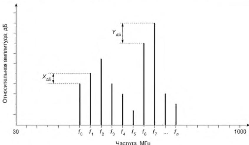
Примечание — В общем случае частота  $f_n = n f_0$ ; частота  $f_0$  является основной частотой эмиссии ИО (основной тактовой частотой).
