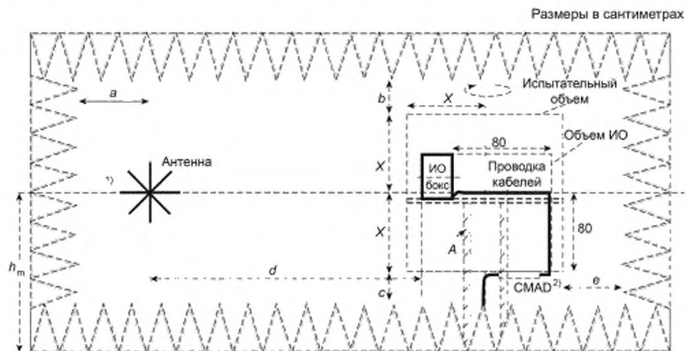
$A$  — поворотная платформа и опора для ИО;  $2X$  — 1,5; 2,5; 5 м, т. е. соответствуют используемому испытательному расстоянию (3, 5 или 10 м соответственно);  $h_m$  — средний уровень испытательного объема;  $a$ ,  $b$ ,  $c$  и  $e$  — рекомендуется (более удобно  $\geq 1$  м), реальное значение — в соответствии с процедурой калибровки FAR по CISPR 16-1-4;  $d$  — 3, 5 или 10 м
