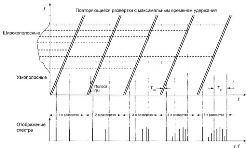
$T_p$  — интервал повторения импульсов импульсного сигнала. Импульс появляется на каждой вертикальной линии отображения спектра относительно времени (верхняя часть рисунка)
