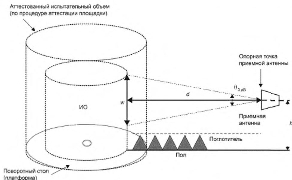
Примечание — Поглощающий материал на пластине заземления показан для иллюстрации. Подробные рекомендации по размещению поглотителя в соответствии с требованиями аттестации площадки приведены в CISPR 16-1-4.
