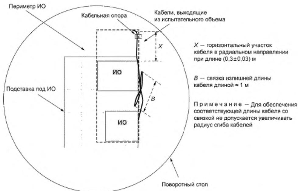
Рисунок 14 — Испытательная установка для напольного оборудования (вид сверху)
