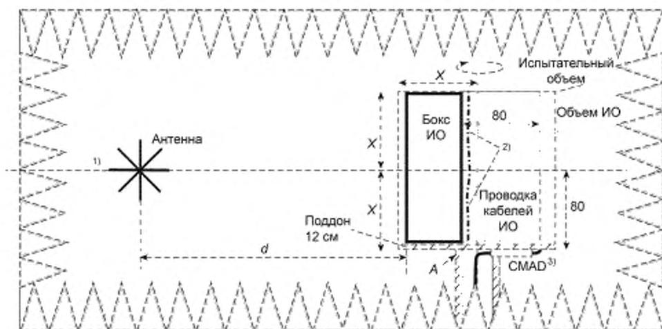
А — поворотная платформа и опора для ИО;  $2X$  — 1,5; 2,5; 5 м;  $d$  — 3, 5 или 10 м (для испытательного расстояния 3, 5 или 10 м соответственно)
