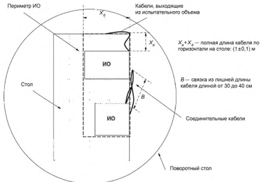
Рисунок 12 — Испытательная установка для настольного оборудования (вид сверху)
