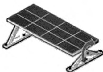
Рисунок 3 — Пример наклонной одноосной системы слежения за Солнцем
