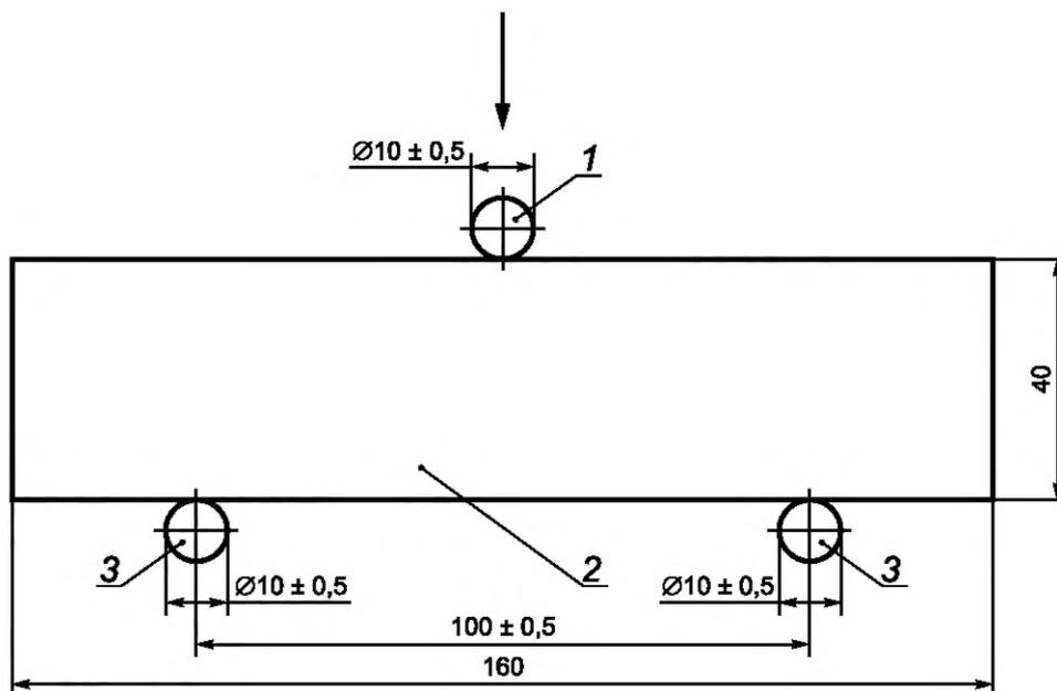
1 — стальной ролик; 2 — испытуемый образец; 3 — опорные стальные ролики
