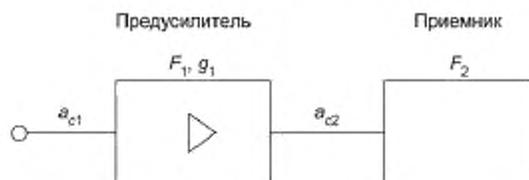
Рисунок J.1 — Измерительный приемник с предусилителем
