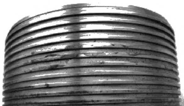
а) Следы коррозии на наружной резьбе
