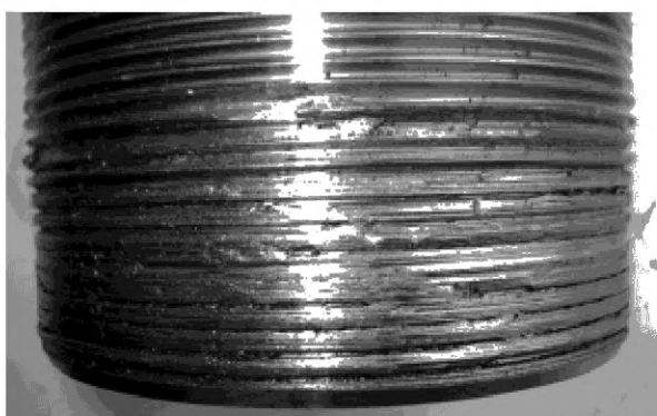
Рисунок 16 — Сорванные витки наружной резьбы
