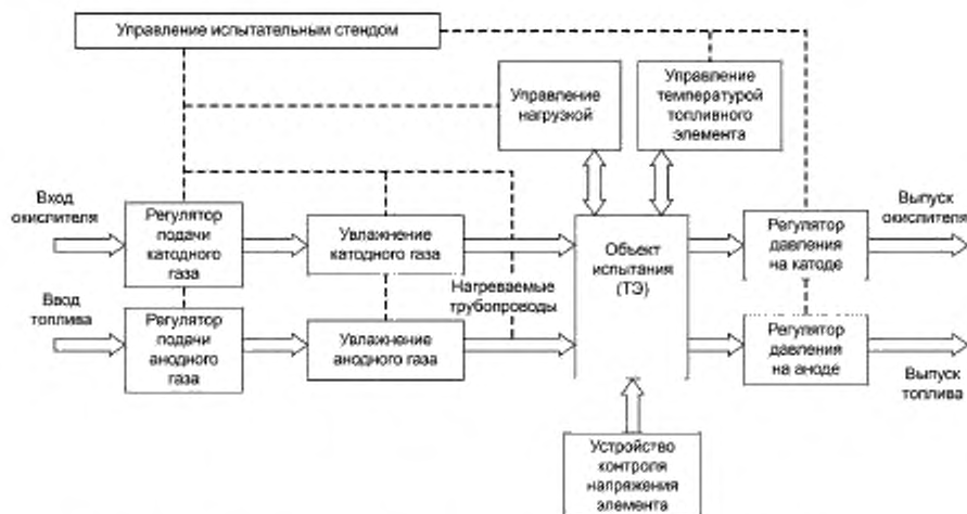
Рисунок 1 — Принципиальная схема стенда для испытания единичного элемента
