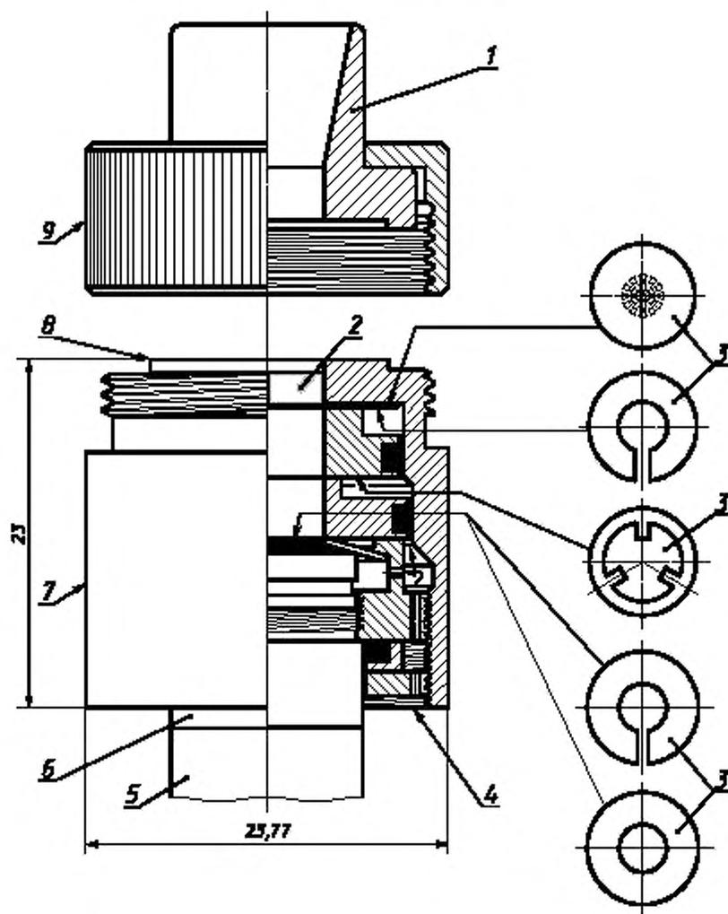
1 — имитатор наружного уха; 2 — пылезащитное приспособление; 3 — прокладка; 4 — отверстия для выравнивания давления; 5 — предусилитель микрофона; 6 — микрофон; 7 — корпус; 8 — опорная плоскость; 9 — гайка с накаткой
