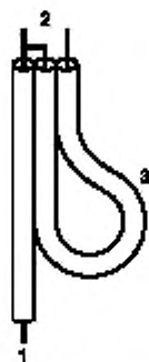
1 — несимметричный вход к средству измерений; 2 — симметричный выход к фидеру; 3 — полуволновая петля
