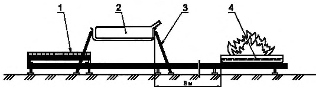
1 — решетка; 2 — топливный бак; 3 — испытательный стенд; 4 — поддон с горящим топливом
