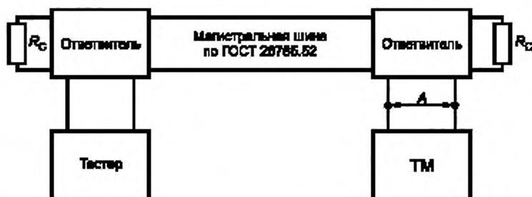
Рисунок 1 — Общая схема тестирования ТМ при имитации физической магистрали
