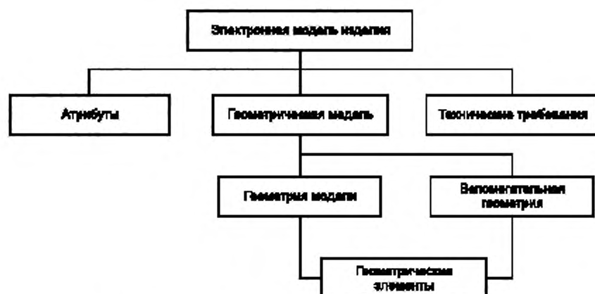
Рисунок Б.1 — Схема состава электронной модели изделия
