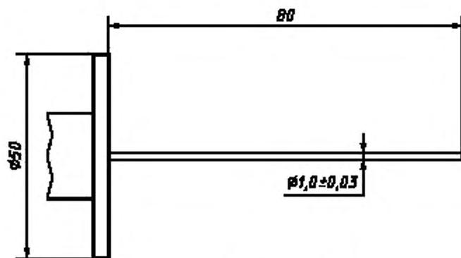
Рисунок 2 — Испытательный щуп
