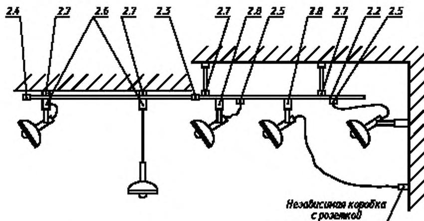
2.2 — секция шинпровода; 2.3 — соединитель; 2.4 — вводное устройство; 2.5 — штепсель светильника (питание только от шинпровода); 2.6 — адаптер (механическое и электрическое присоединение к шинпроводу); 2.7 — подвес шинпровода (к потолку, к подвеске из труб или проволоки); 2.8 — подвес светильника
