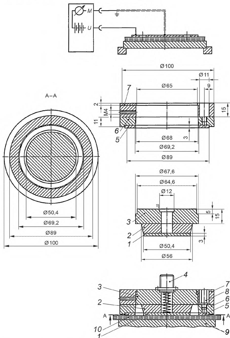
1 — измерительный электрод; 2 — изоляционный диск; 3 — защитная пластина; 4 — разъем подключения коаксиального кабеля; 5 — кольцевой электрод; 6 — изоляционное кольцо; 7 — экранирующее кольцо; 8 — соединитель; 9 — основание; 10 — образец
