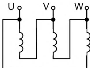
Рисунок 2 — Одиночная трехфазная обмотка, соединение треугольником, три вывода
