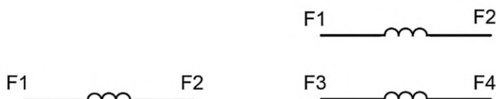
Рисунок 21 — Независимая обмотка возбуждения, один и два элемента
