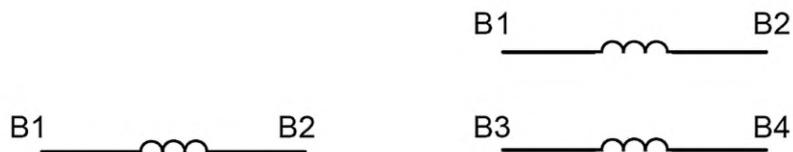
Рисунок 17 — Коммутационная обмотка, один и два элемента
