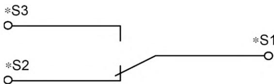
Рисунок 33 — Соединения переключателя
