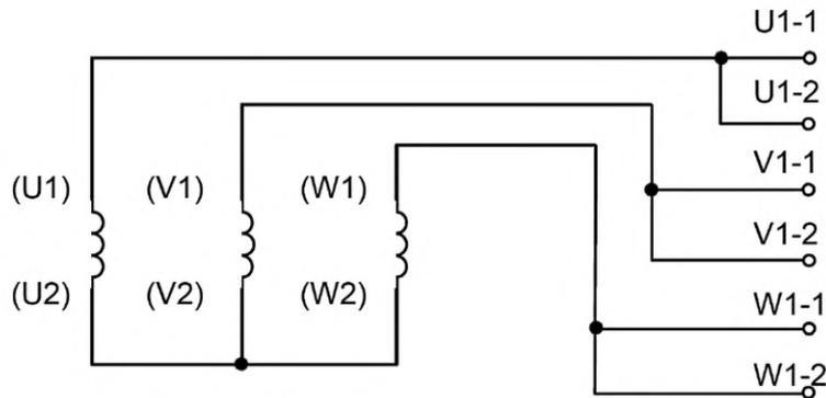
Рисунок 10 — Одиночная трехфазная обмотка, соединение звездой, параллельные выводы для общего тока, шесть выводов
