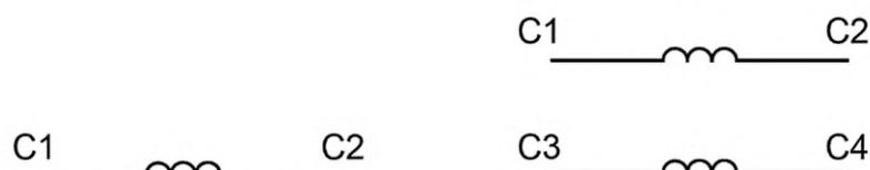
Рисунок 18 — Компенсирующая обмотка, один и два элемента
