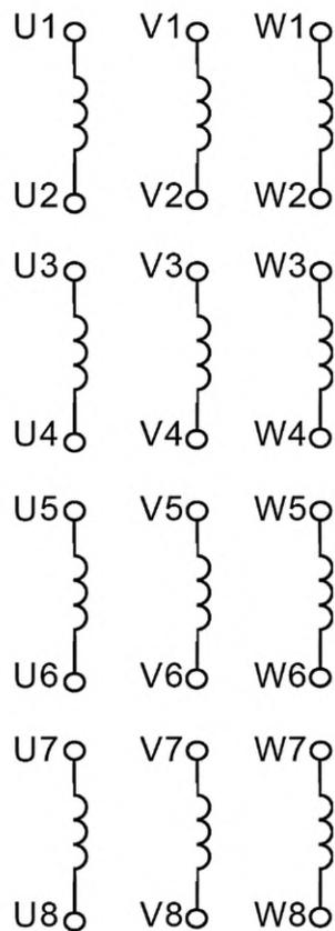
Рисунок 5 — Одиночная трехфазная обмотка, четыре элемента на каждую фазу, разомкнутое соединение, двадцать четыре вывода
