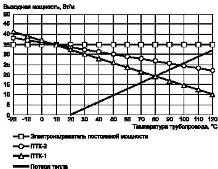
Рисунок 3 — Условия равновесия для поддержания температуры в трубопроводе
