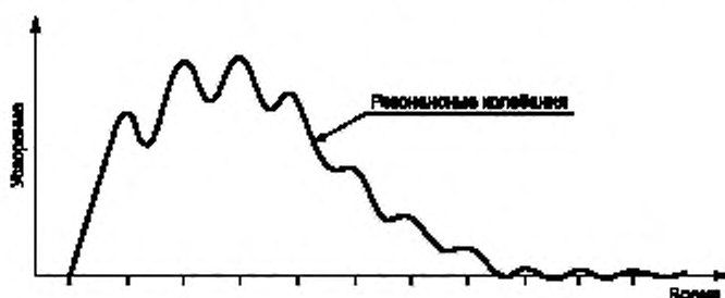
Рисунок 4 — Отклик акселерометра на удар
