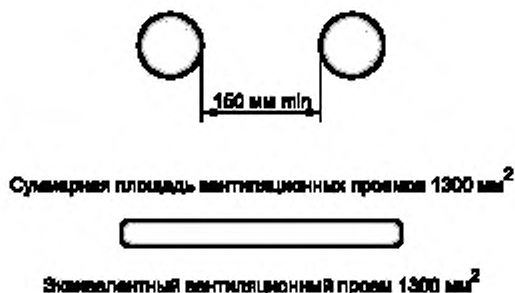
Рисунок 6 — Пример разных конструкций вентиляционных отверстий
