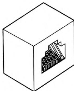
Рисунок 2 — 8-контактное гнездо
