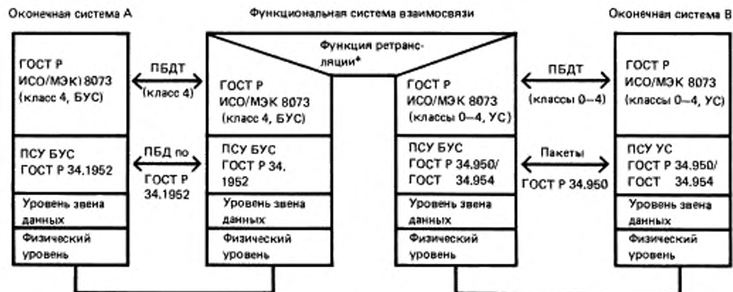
Рисунок 1 — Пример конфигурации активной ретрансляции на транспортном уровне
