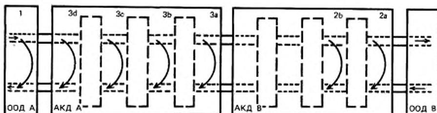
**Примечание** — Каждая АКД должна реализовывать, по меньшей мере, один из двух шлейфов типа 2 (шлейф 2a или 2b) для проверки со стороны линии и, по меньшей мере, четыре шлейфа типа 3 (шлейфы 3a, 2b, 3c или 3d) для проверки со стороны локального окончания.
