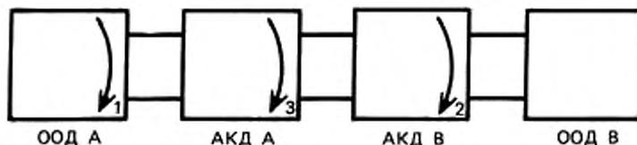
Примечание — Каждая АКД может реализовать два шлейфа, т. е. проверочный шлейф 2 для проверки со стороны линии и проверочный шлейф 3 для проверки со стороны локального окончания.
