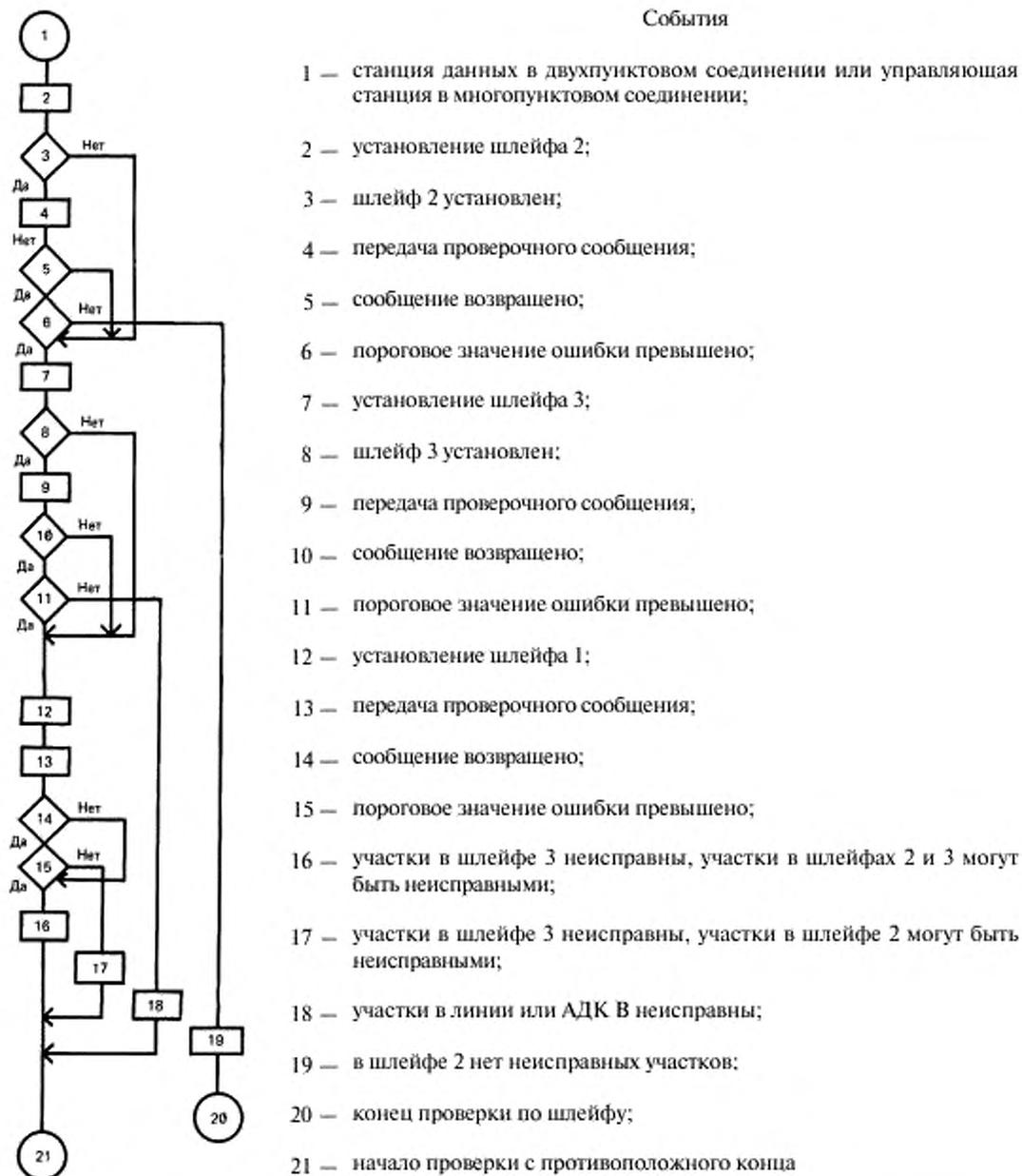
Примечание — Если соединение не установлено, то блок-схема оценки проверки начинается с события 7.
