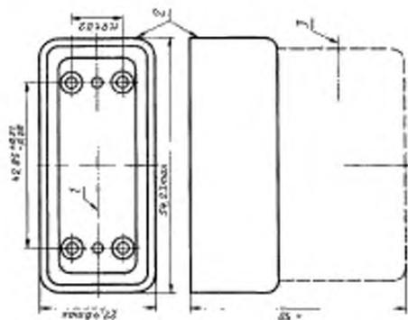
1 — осевая линия резьбовых систем, 2 — монтажный фланец, 3 — корпус
