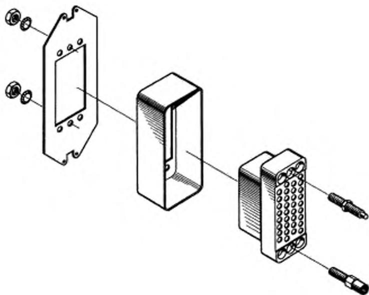
Рисунок 5 – Иллюстрация монтажа соединителя АКД
