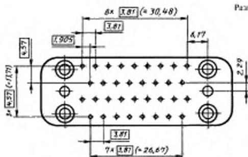
Рисунок 3 — Размеры контактного пространства
