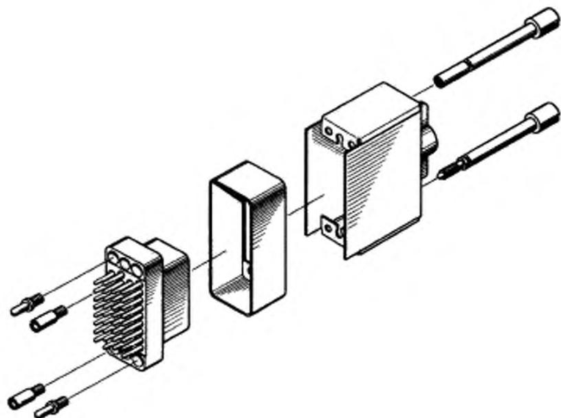
Рисунок 9 — Иллюстрация монтажа соединителя ООД
