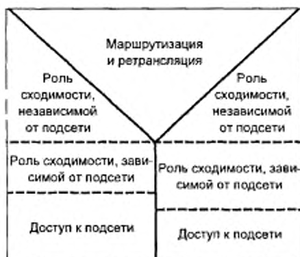
Рисунок В.1 — Внутренняя структура функций С-логического объекта ретрансляции
