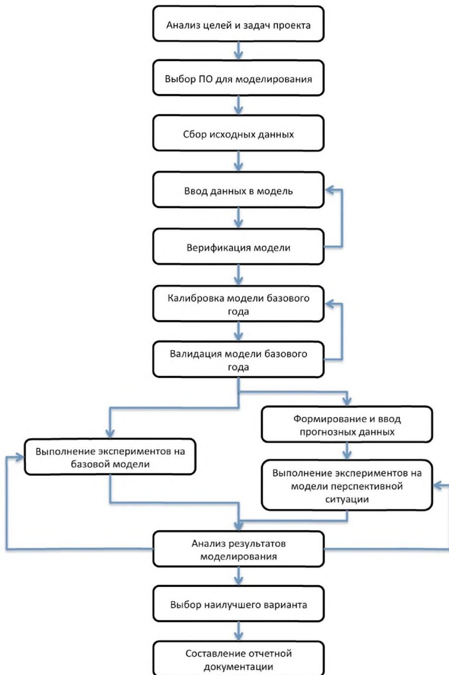
Рисунок 1 – Блок-схема процесса построения модели участка УДС
