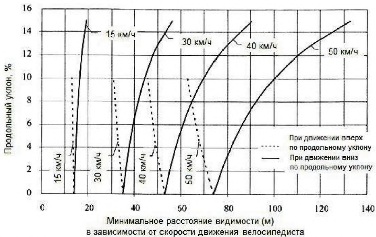
Рисунок 3.4. Расстояние видимости до остановки в зависимости от скорости движения велосипедиста и продольного уклона
