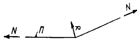
Рис. 2.4.1.1 Усилия от продольного изгиба корпуса в месте слома палубы:
