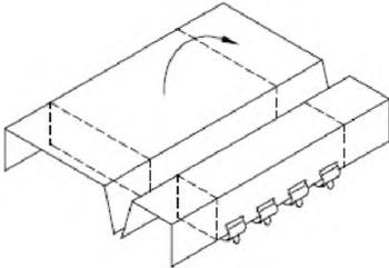
Этап 2: Корпуса закрепляются под прямыми углами. Края избыточного покрытия отгибаются вниз и назад к сторонам испытательного стенда.
