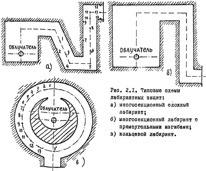
Рис. 2.1. Типовые схемы лабиринтных защит:
