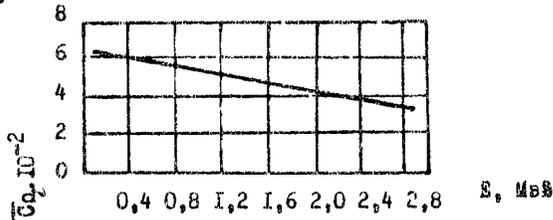
Рис. 2.3. Энергетическая зависимость константы  $C_{0i}$  для бетонных лабиринтов.
