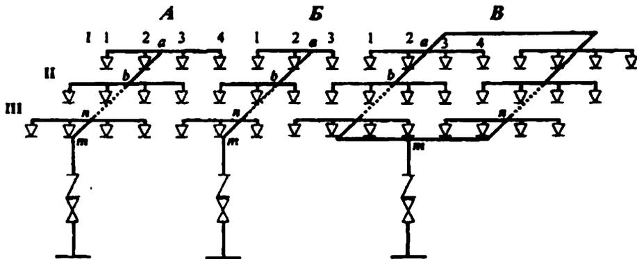
Рис. 1 Схемы распределительной сети спринклерной или дренажной АУП:
