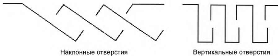
Рисунок 4В – Примеры поперечного сечения конструкции отверстий, предотвращающих вертикальный доступ
