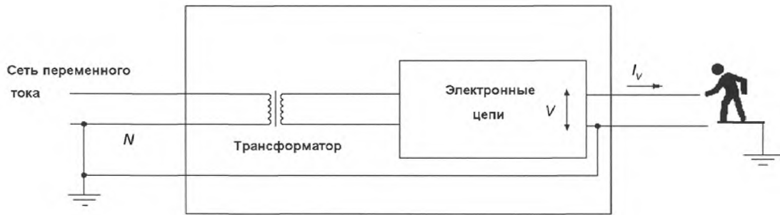
Рисунок W.2 – Ток прикосновения от заземленной цепи
