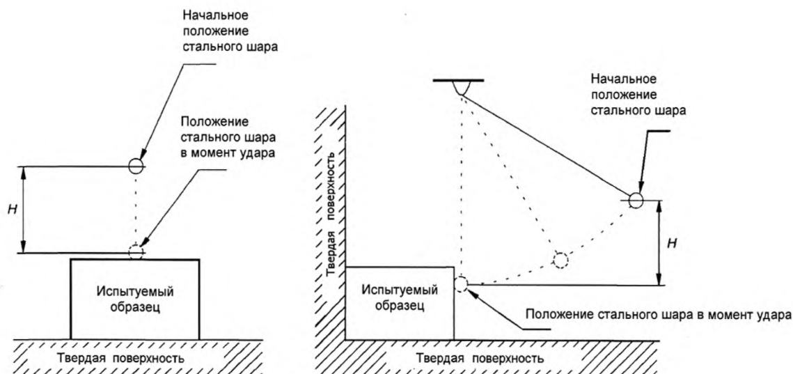
Рисунок 4А – Испытание на удар с использованием стального шара
