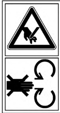
Рисунок В.1 – Опасности, связанные с движущимися частями
