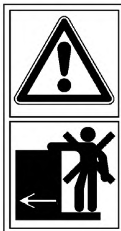
Рисунок В.3 – Опасность подъема на движущуюся машину
