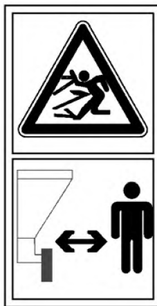
Рисунок В.2 – Опасности, связанные с выбросом материалов
