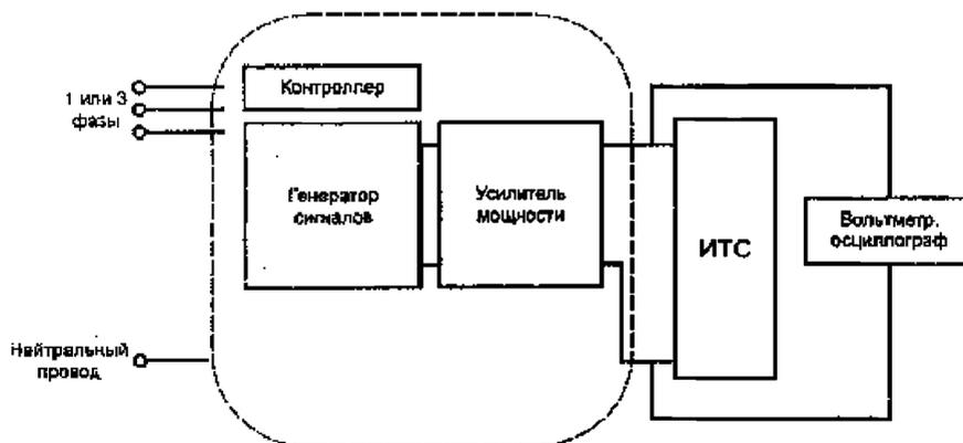
Рисунок 3 — Схема испытательного оборудования с услителем мощности
