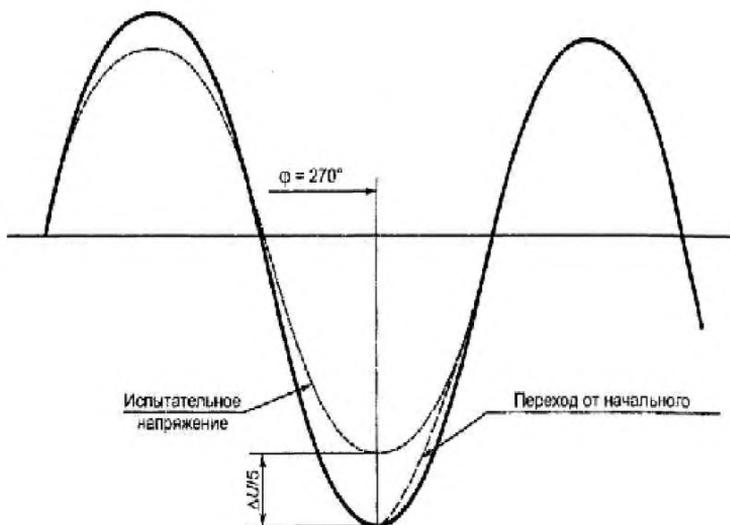
Рисунок 1в — Изменение напряжения в течение 0,25 периода при образовании  $t_f$  и  $t_r$
