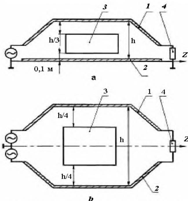
а – преобразователь с несимметричным питанием: 1, 2 – электроды, образующие линию (1 – электрод с нулевым потенциалом), 3 – рабочий объем, 4 – нагрузка;
