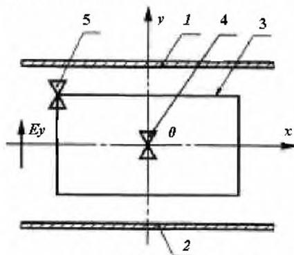
1, 2 – электроды преобразователя; 3- рабочий объем; 4 – ДАД в центре рабочего объема; 5 – ДАД в одной из вершин параллелепипеда, ограничивающего рабочий объем; 0 - центр рабочего объема;  $E_y$  – вектор напряженности электрического поля в системе координат XYZ, ось Z направлена от плоскости чертеж и совпадает с направлением распространения волны
