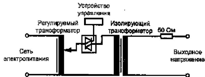
Рисунок 4- Схема ИГ на частоте 50 Гц
