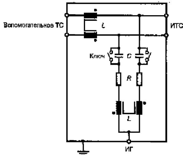
Примечание – R=200 Ом; C=4,7 мкФ (конденсатор должен быть замкнут при подаче помехи постоянного тока); L=2·38 мГн (бифилярная обмотка)
