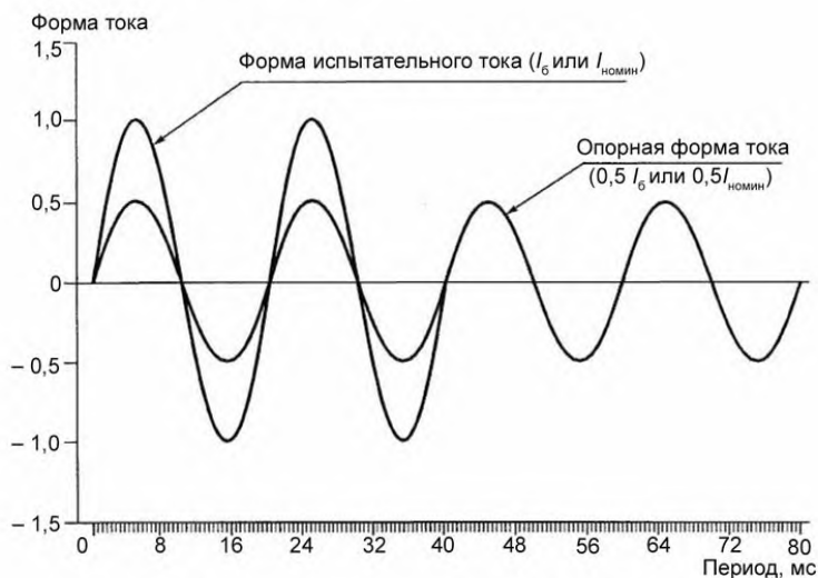
Рисунок А.7 – Форма тока при управлении «пачками периодов»
