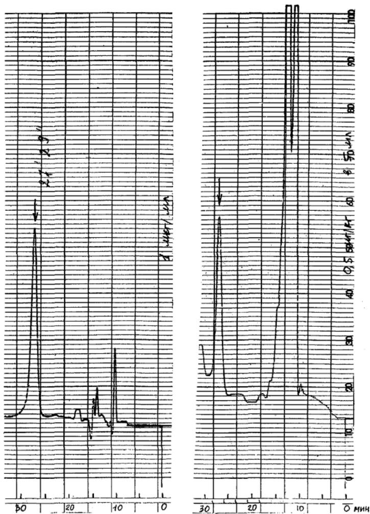
Рис. 10. Хроматограммы образцов зерна кукурузы: титус - 1 мкг/мл (стандарт); внесено в образец - 0,5 мкг/кг. Усилитель  $\times 50$ . Хроматограф Waters 510.
