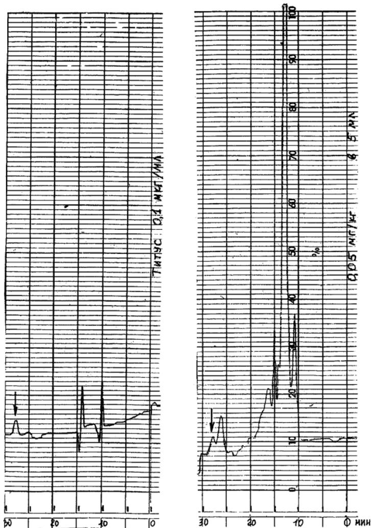
Рис. 8. Хроматограммы образцов зеленой массы кукурузы: титус - 0,1 мкг/мл (стандарт); внесено в образец - 0,05 мг/кг. Усилитель  $\times 50$ . Хроматограф Waters 510.
