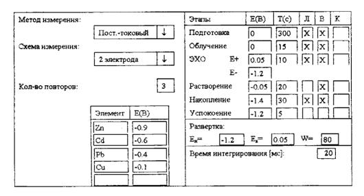
Рисунок 2 – Программа «Определение ТМ»
