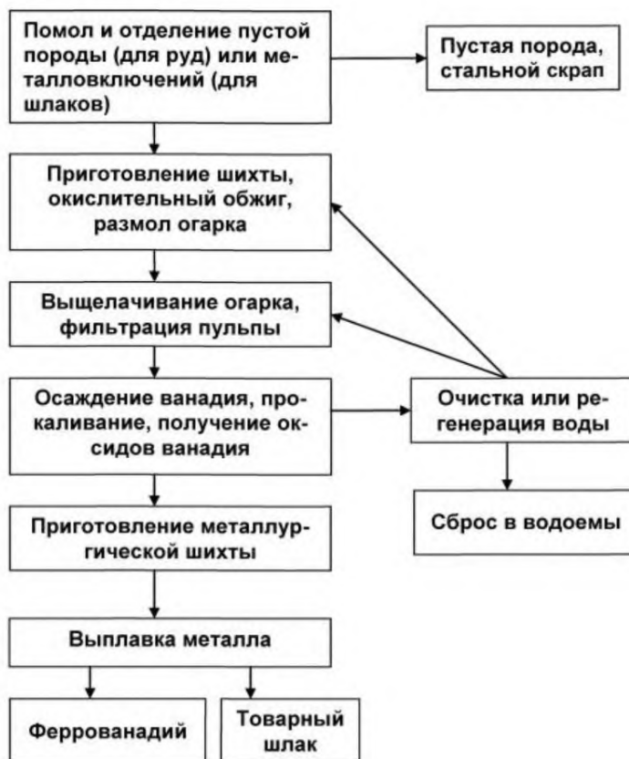
Рисунок 2.81 — Принципиальная схема производства оксидов ванадия и феррованадия
