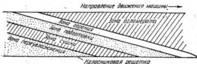
Рисунок 2.1 — Зоны в слое спекаемой шихты на аглоленте [40]
