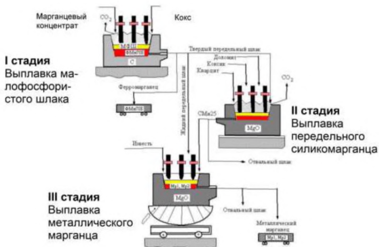
Рисунок 2.77 — Трехстадийная технологическая схема производства металлического марганца с получением на первой стадии высокоуглеродистого ферромарганца ФМн78Б и малофосфористого передельного шлака
