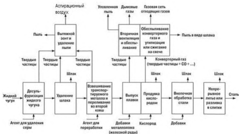
Рисунок 3.14 — Блок-схема процесса кислородно-конвертерного производства стали с указанием источников выбросов [113]
