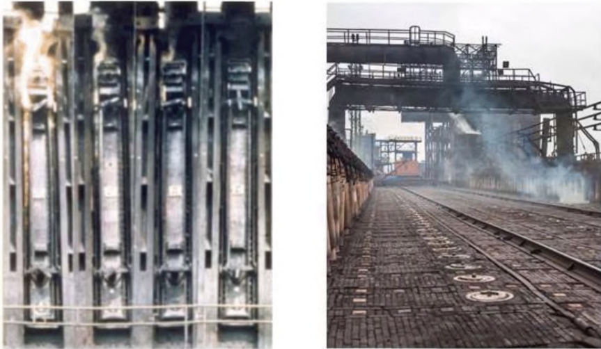
Рисунок 3.5 — Примеры газовыделений из дверей и люков коксовых печей
