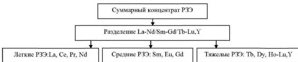
Рисунок 2.16 – Схема 2 разделения группового бастанезитового концентрата РЗЭ, реализованная на предприятиях в Китае
