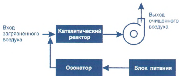
Рисунок 29 — Пример озонно-каталитической очистки [67]
