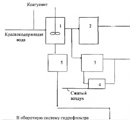
Рисунок 5 — Схема очистки краскосодержащих сточных вод [63]
