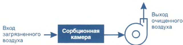
Рисунок 23 — Пример сорбционной очистки воздуха [67]
