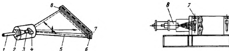
Рисунок 10 — Керамический излучатель с отражателями [62]
