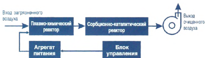
Рисунок 30 — Пример сорбционно-плазмо-каталитической очистки [67]
