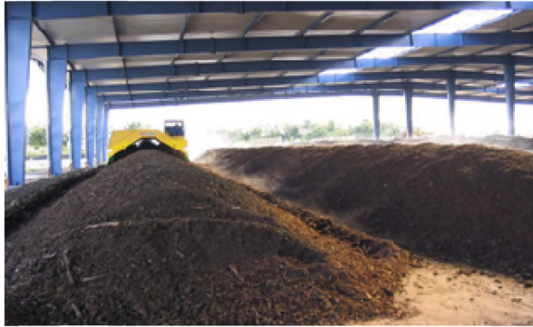
Рис. 5.1 — Перемешивание и аэрация буртов
