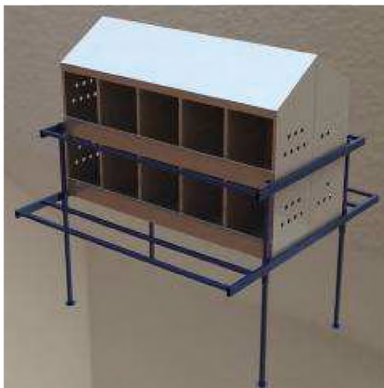
Рис. 2.7 — Внешний вид секции гнезд для родительского стада
