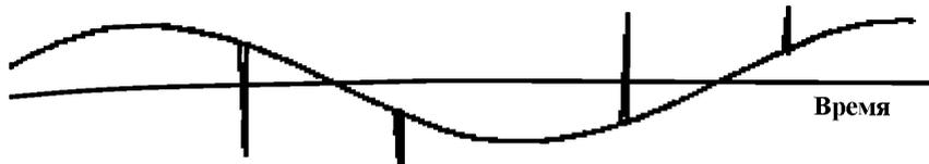
Самокоммутация: Двухточечное импульсное напряжение
