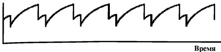
Нагрузочная коммутация: Заземленное импульсное напряжение
