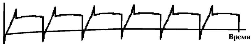
Самокоммутация: Заземленное импульсное напряжение
