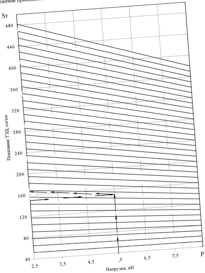
Рис.3 Номограмма для приведения показаний толчкомера ТЭД-2М к нормированной нагрузке в кузове базового автомобиля.
