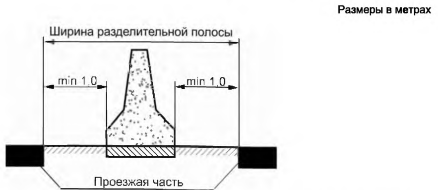
Рисунок Г.11 – Расположение недеформируемого дорожного ограждения на разделительной полосе
