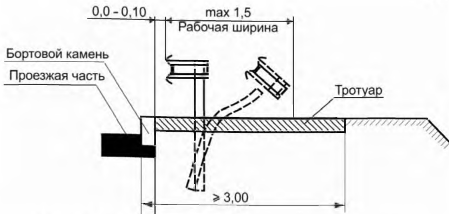
Рисунок Г.6 – Рабочая ширина деформации дорожного ограждения, установленного на тротуаре
