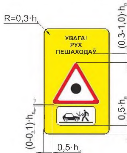
Рисунок Г.9 – Пример компоновки изображений знаков 1.29 и 7.22.3, расположенных на фоновом щите желтого цвета
