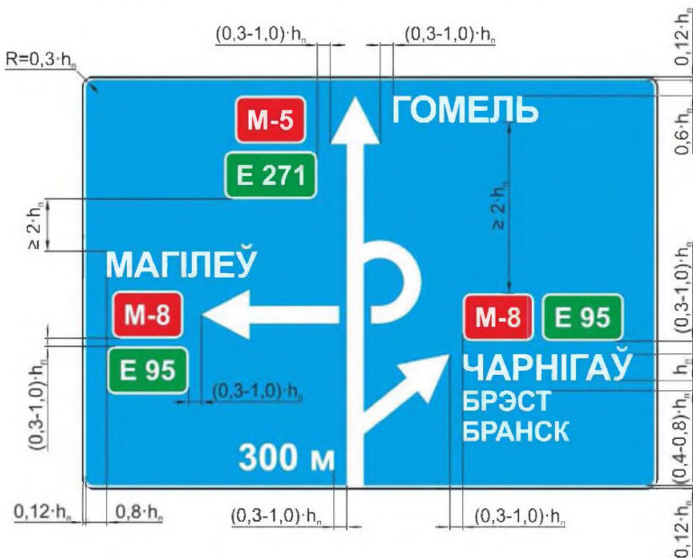
Рисунок Г.1 – Пример компоновки изображения знака 5.20.1
