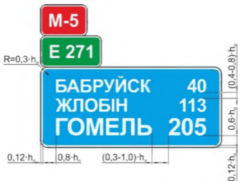
Рисунок Г.4 – Пример компоновки изображений знаков 5.27 и 5.29.1
