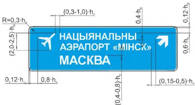
Рисунок Г.2 – Пример компоновки изображения знака 5.20.2
