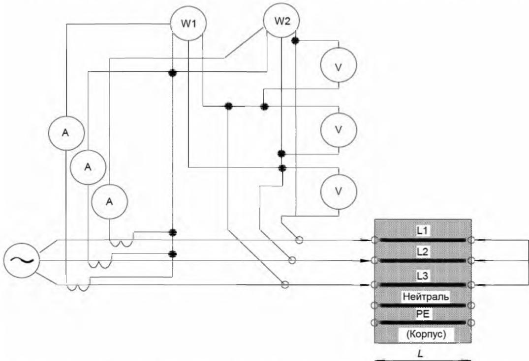
Примечание – Общая трехфазная активная мощность системы определяется по диаграмме методом двух ваттметров, но могут использоваться и другие типы ваттметров, например трехфазные и однофазные.
