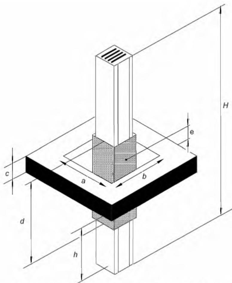
*a, b* – ширина и длина отверстия испытательного пола; *c* – толщина испытательного пола;
