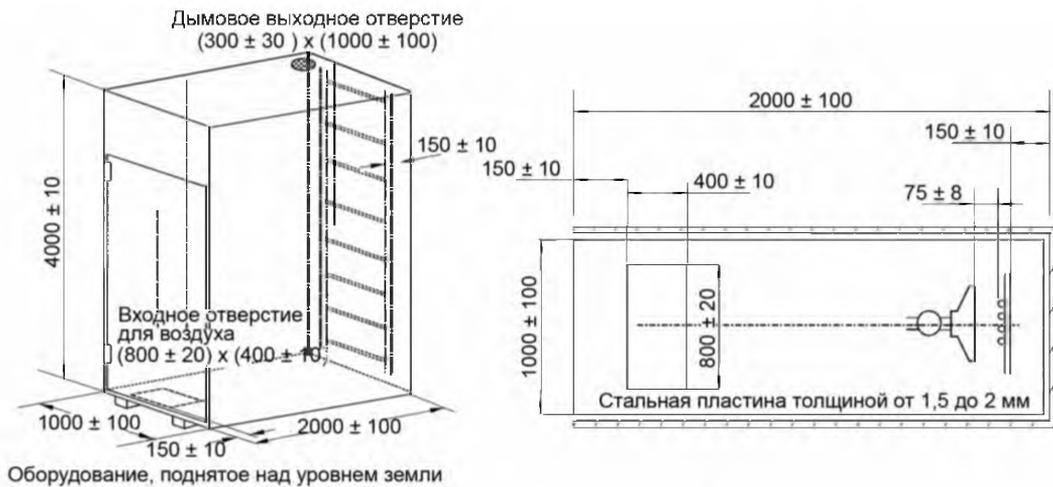
Рисунок М.1 – Пример испытательной камеры
