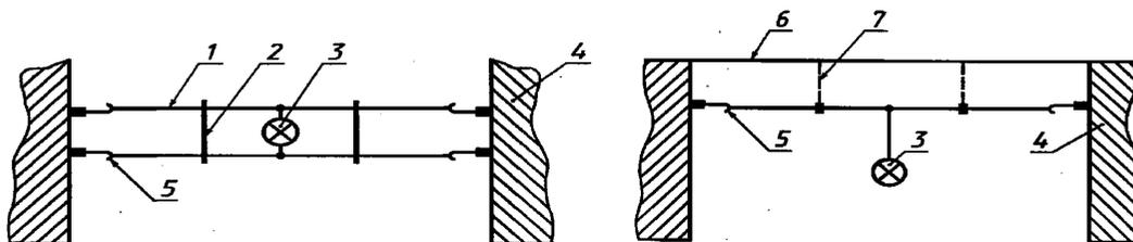
1 – несущий проводник; 2 – распорка; 3 – светильник; 4 – стена;
